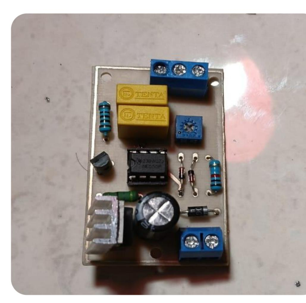
Pulse Width Modulator adalah modul yang digunakan untuk mengontrol kecepatan motor DC. Kami menggunakan komponen IC NE 555 untuk generator sinyal dengan duty cycle yang dapat diatur, transistor MOSFET IRF 540 sebagai switch,
