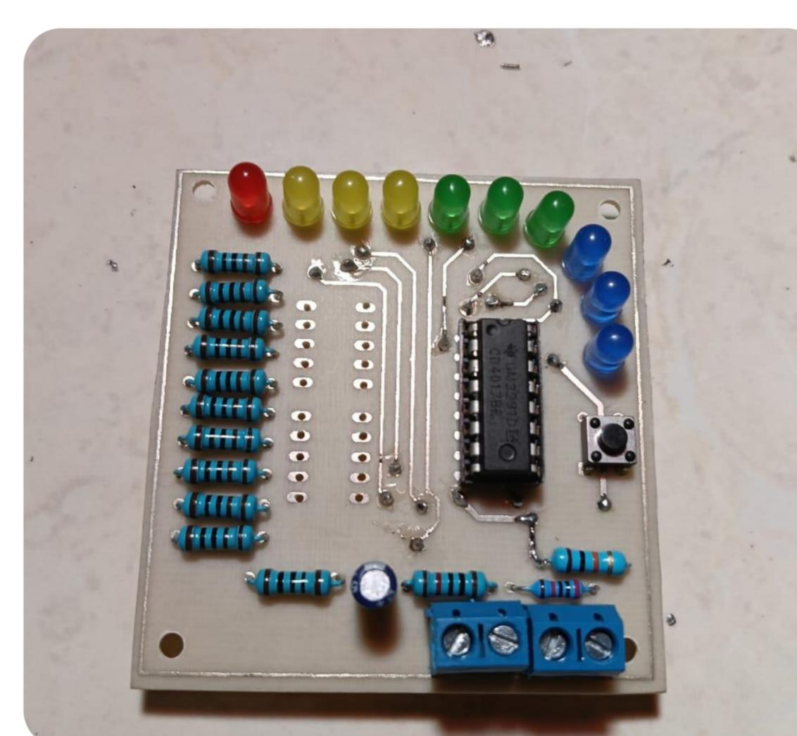
Untuk mendeteksi berapa kali sensor melewati gate. Kami menggunakan IC CD 4017 dan dip switch untuk mengatur konfigurasi berapa kali sensor mendeteksi gate untuk berhenti.
